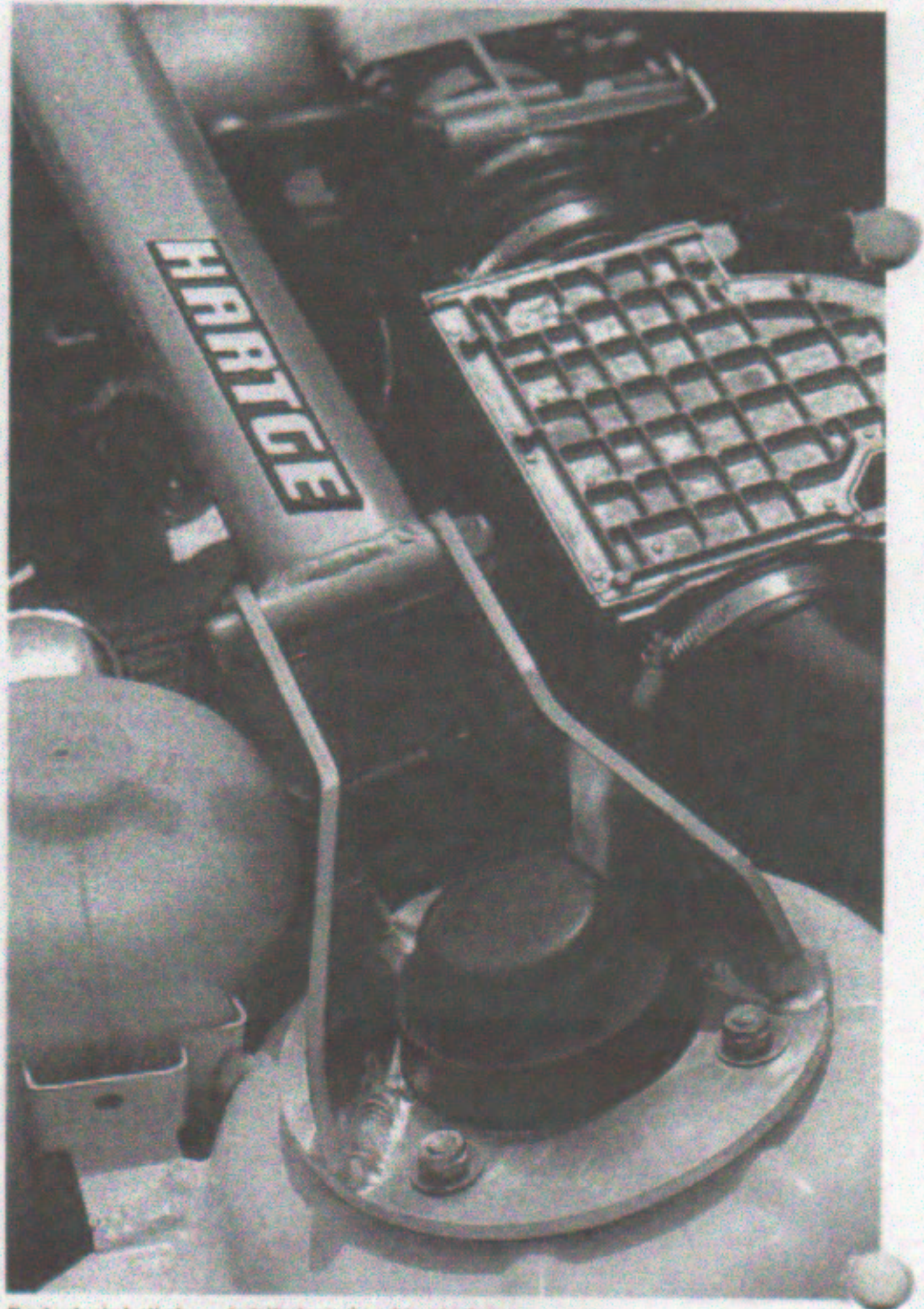
Federbeinbrücke, stabilisiert den Vorderbau, besonders empfehlenswert für Reifen der Serie 50, 60 und TXR-Reifen
