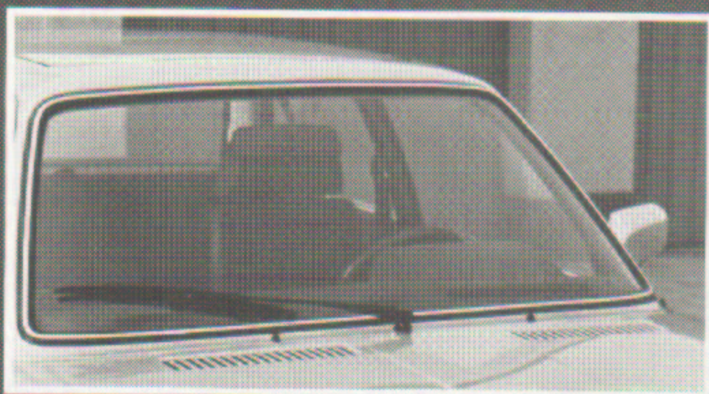
Einarm-Scheibenwischer Umbau 316 - 323i Auch lieferbar für den BMW 5E28, gute Wischleistung auch bei hoher Geschwindigkeit
