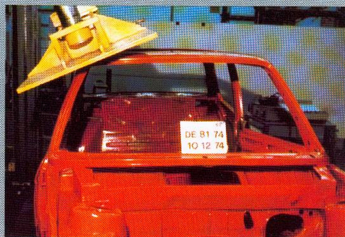
Contrôle de résistance des traverses et longerons du toit ainsi que de l'arcade de protection à titre de précaution contre les renversements et tonneaux.
