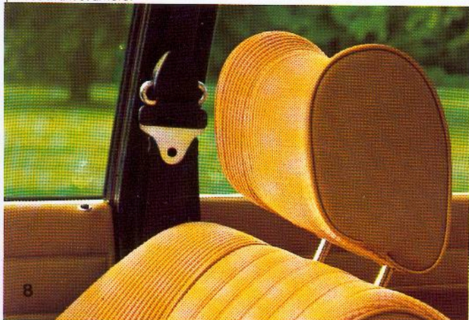
Sécurité systématique obtenue par la combinaison d'appuis-tête réglables en hauteur par bouton-poussoir et de ceintures de sécurité automatiques à trois points de fixation.
