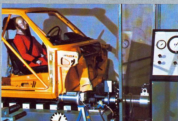
Mise en évidence des dispositifs de sécurité dans le cockpit grâce à une simulation d'impacts réalisée avec des chariots d'essai.
