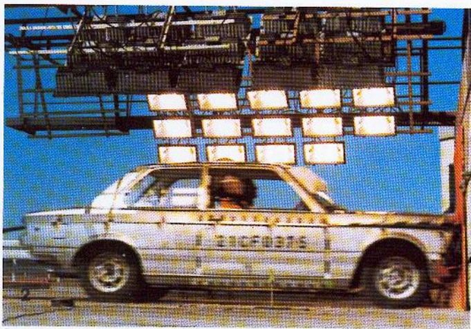
Essai de collision pour mise en évidence du comportement à la déformation des parties avant et arrière.
